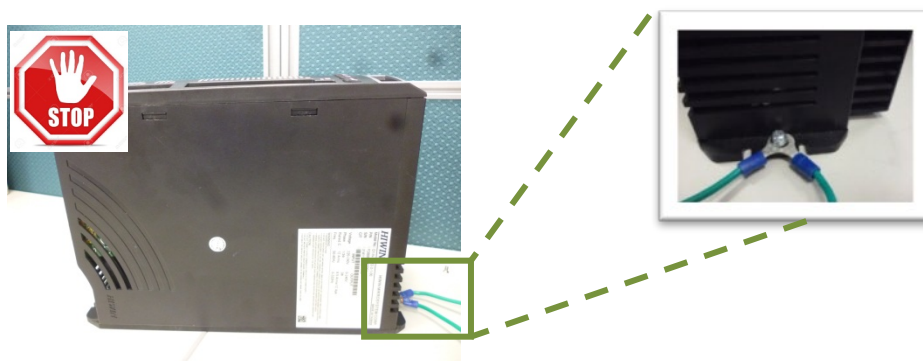
圖15.2.3 D1-N-09/18/36接地禁止方式
