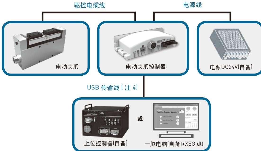
• 通讯方式：序列通讯Modbus RTU
